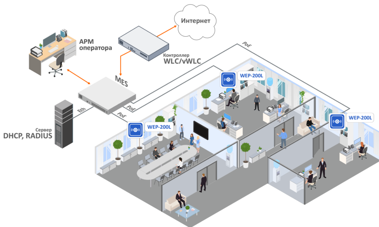
Рисунок 1 – Функциональная схема использования WEP-200L
